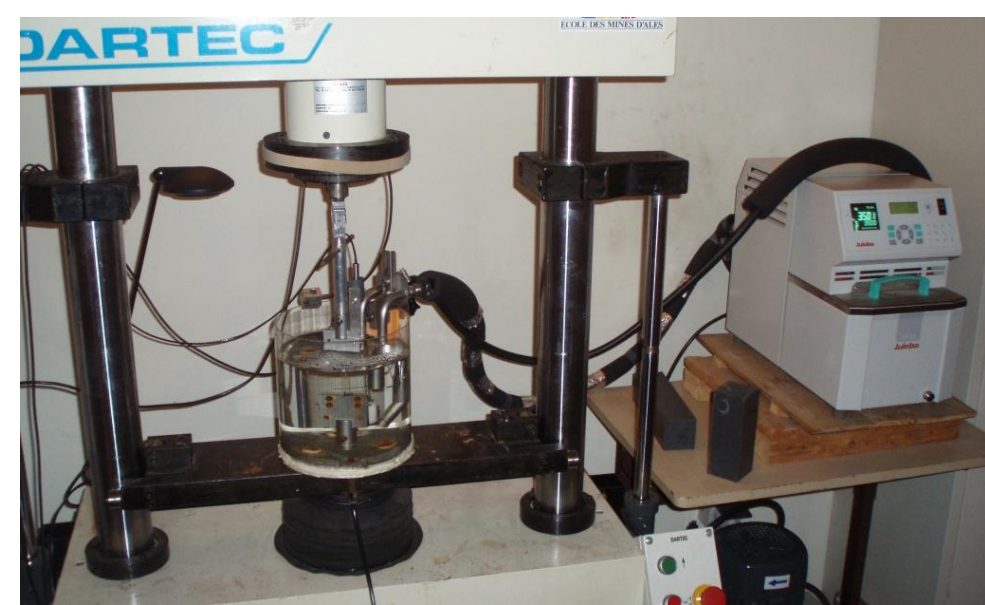
Vieillessement couplé d'un PLA/Lin, (th A. Régazzi)
